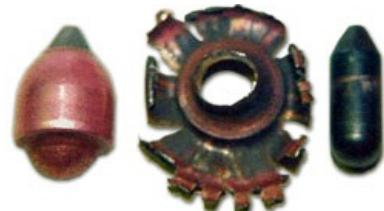
Пуля патрона 9×18 ПБМ до и после попадания в стальную пластину
